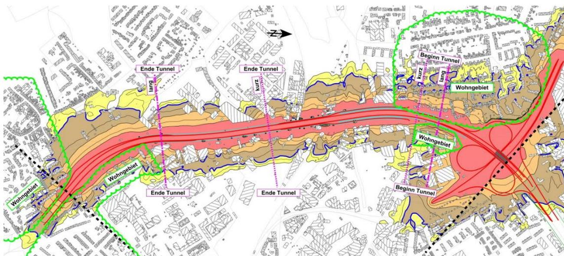
**Abbildung 3.38 Schallimmissionsplan Variante T1 (Nachtzeitraum) – Adaption Tunnel**
